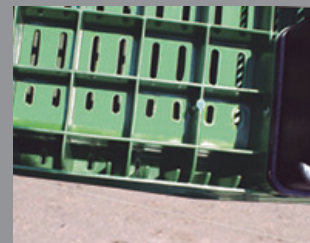
Salidas inferiores para evitar acumulación de líquidos
