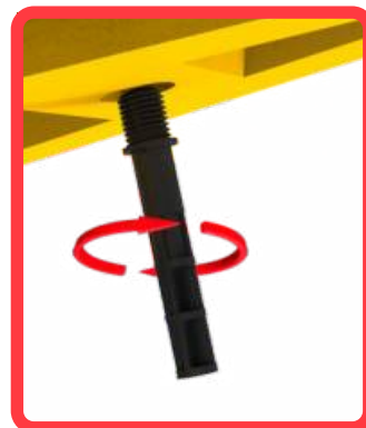
Colocación de pernos
